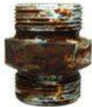
Zink-Basissschicht + Passivierung und Versiegelung Zink base coat + passivation and seal
