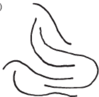
Plastomere - keine Vernetzung Plastomere - no crosslinking
