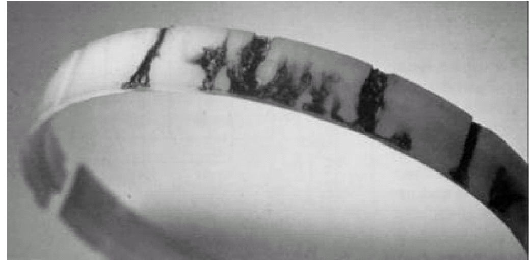
Bild 9.15 Durch Dieseleffekt zerstörte Dichtung und Führung Fig. 9.15 Seal and guide ring destroyed by diesel effect
