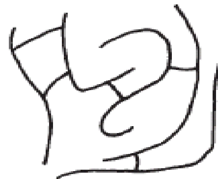
Elastomere - weitmaschige Vernetzung Elastomere - wide-meshed crosslinking
